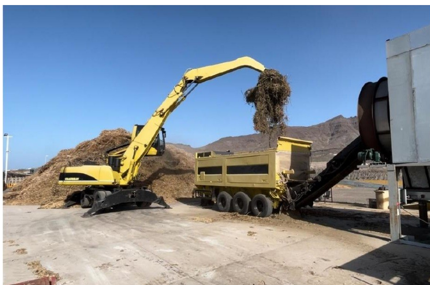
Alimentación de residuo agrícola en la línea de proceso.
