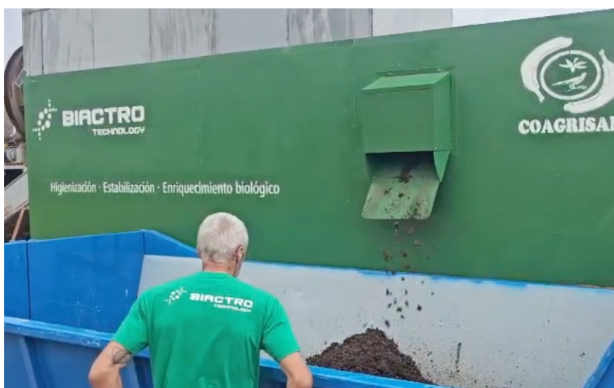
Descarga de enmienda Clase A a la salida del módulo de biocatálisis.
